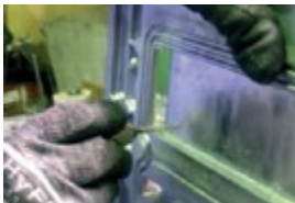
Za brušenje varilnega šiva med jeklenima ploščama
