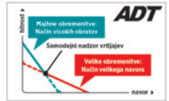
Avtomatsko prilagajanje navora glede na obremenitev
