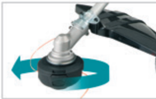
Obratna smer vrtenja odstrani zataknjeno travo
