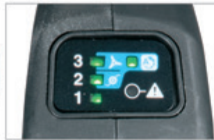
Izbira načina glede na tip rezila rezila/najlonska nitka
